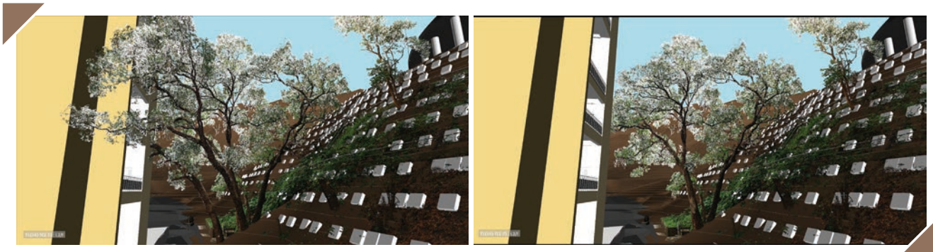
結合建築信息模擬技術與「現實捕捉」技術以作樹木保育研究 — 結合前(左圖)和結合後的影像
