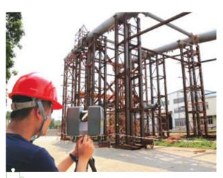
坐地式雷射測量技術 Terrestrial laser scanner
