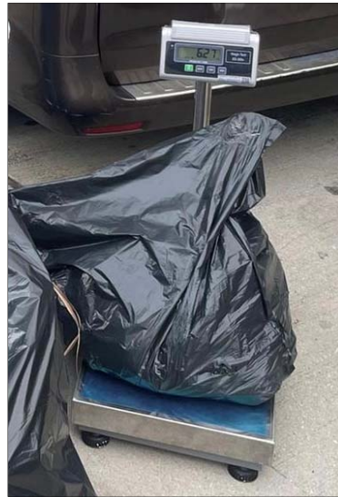
圖中顯示承辦商使用座地感重裝置進行量度收集到的沿岸垃圾數量
