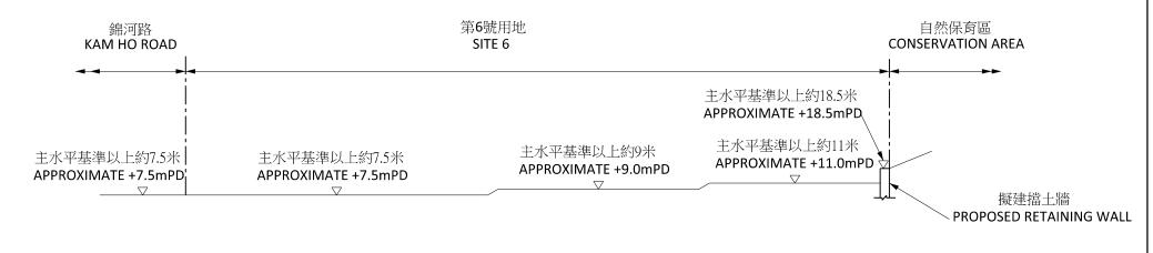
剖面圖 D-D SECTION D-D 比例 SCALE: N.T.S
