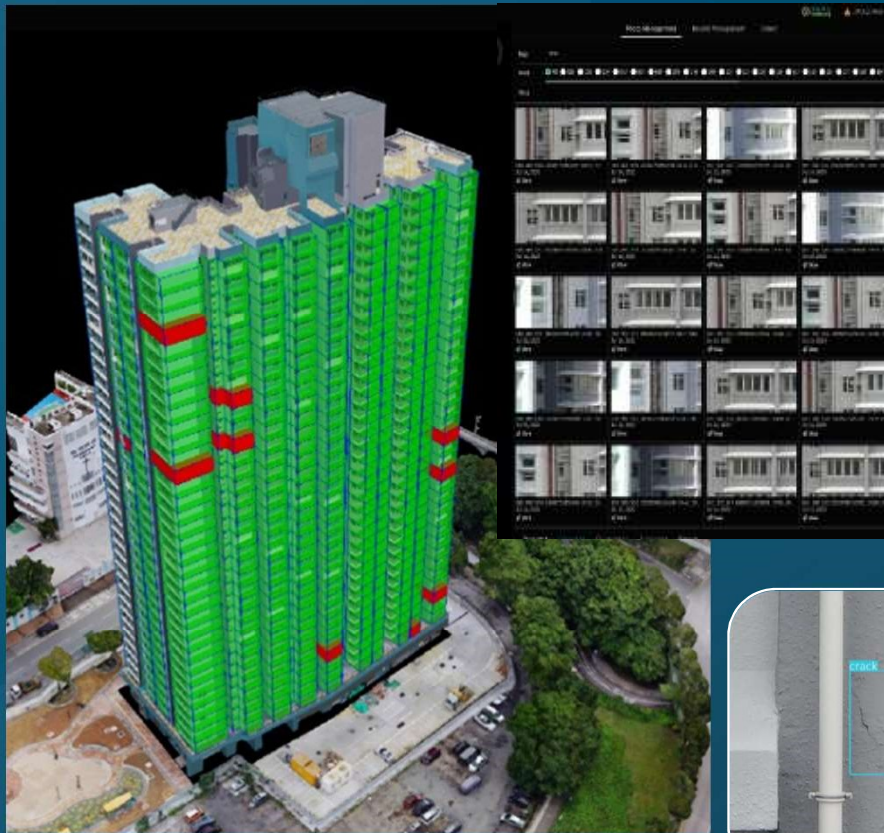
利用小型無人機配合人工智能技術檢測外牆
