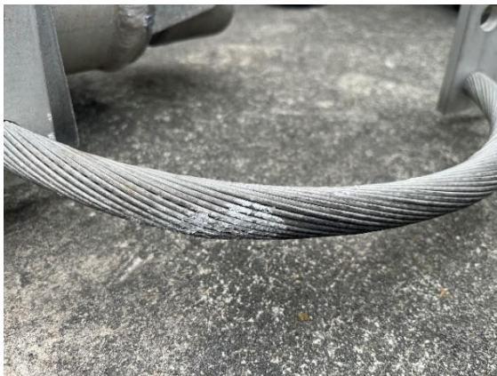
圖 11. 輕微受損的 C5 軟連接導體
