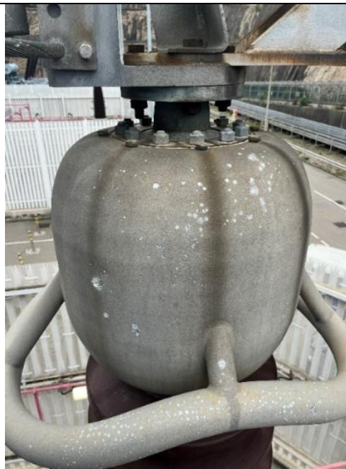
圖 12. C6 連接器頭表面的金屬熔解痕跡
