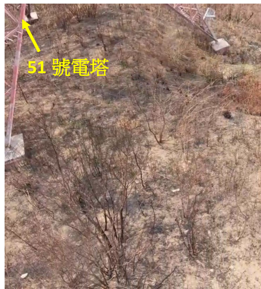
圖 2：L3 相導線閃絡痕跡下方燒焦的樹
