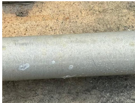
圖 12. C5 高壓跳線表面的金屬熔解痕跡
