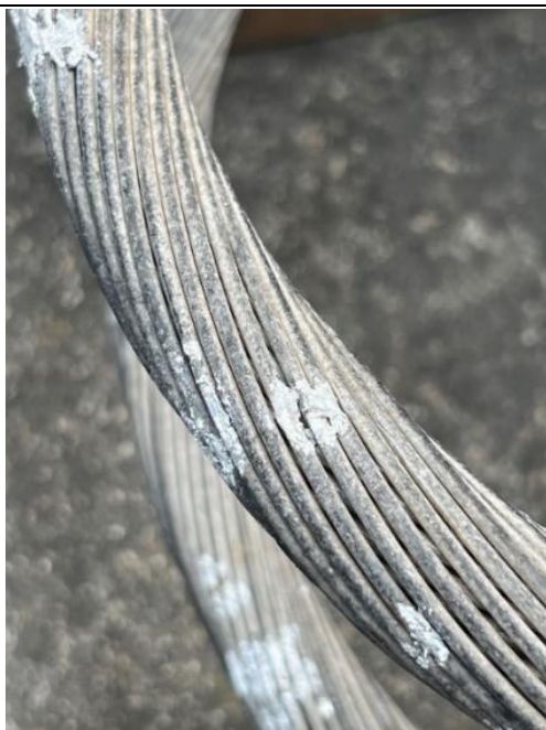
圖 13. 輕微受損的 C6 軟連接導體
