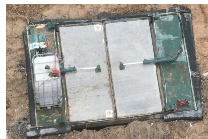
金屬蓋在有需要棄置禽畜廢物時才打開， 減低氣味散發的可能性
