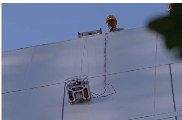
檢測人員於物業天台操作機械人檢測樓宇結構安全
