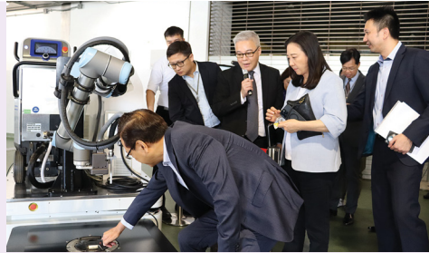
(左) 機場跑道助航燈自動維護機械人可自動偵測和清潔跑道燈，騰出手處理其他工作。該創新方案大幅提升維修效率，同時確保跑道安全。
